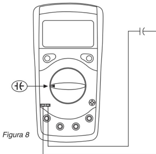
**⚠ ADVERTENCIA** Para evitar daños al multímetro o a los dispositivos que está probando, desconecte el circuito de corriente que está probando al medir capacitores en línea y descargue todos los capacitores de alta tensión antes de medir la capacitancia. Use la función de tensión de c.c. para confirmar que el capacitor se ha descargado.
