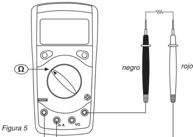
**⚠ ADVERTENCIA** Para evitar daños al multímetro o a los dispositivos que está probando, desconecte el circuito de corriente y descargue todos los capacitores de alta tensión antes de realizar pruebas de resistencia.
